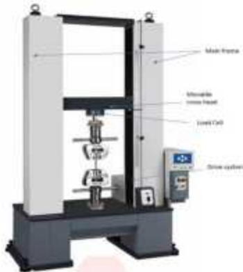
Gambar 5. Mesin tensile tester (Mathew dan Francis, 2019)
