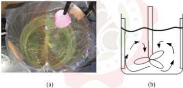
Gambar 8. Tangki Pengaduk (a) Kondisi di Perusahaan (b) Ilustrasi Pengadukan
