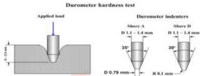
Gambar 10. Skema Pengujian Kekerasan
