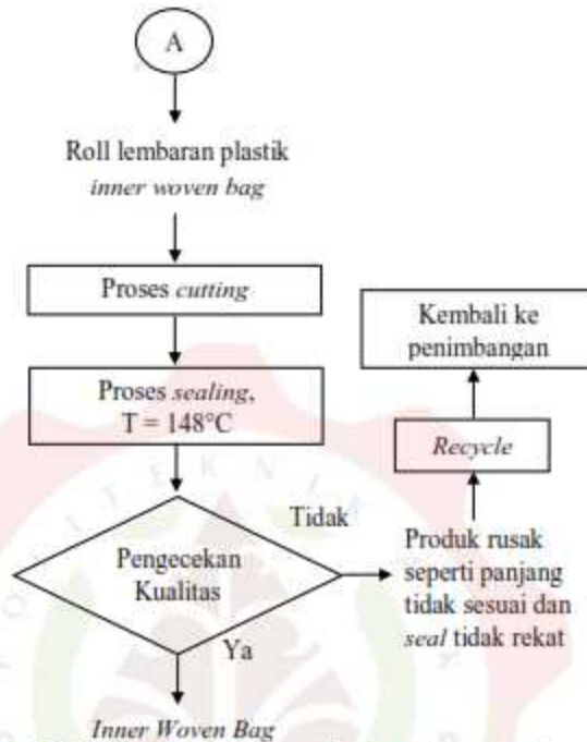
Gambar 15. Diagram alir proses pembuatan inner woven bag Sumber: PT. Gunawan Fajar
