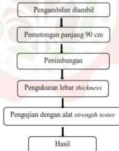
Gambar 9. Diagram alir proses pengujian benang plastik
