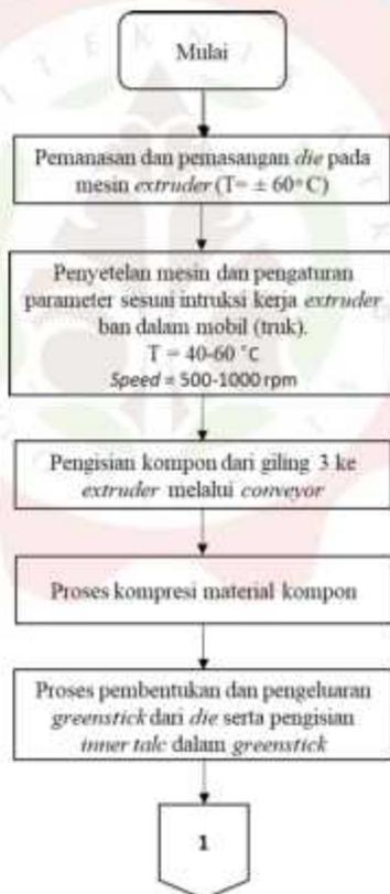
Gambar 10. Diagram alir proses ekstrusi
