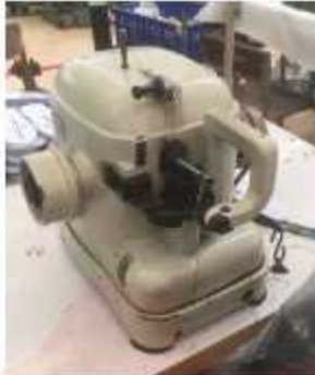
Gambar 17. Mesin Jahit Strobel (Sumber: PT. Wangta Agung)
