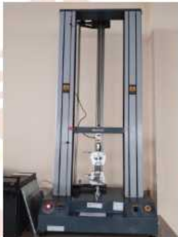
Gambar 2. Universal Testing Machine (UTM) Sumber : Lab Uji Fisis Politeknik ATK Yogyakarta
