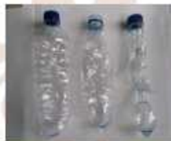
Gambar 4. Cacat gagal tiup (Sumber: Tasnim, 2017)
