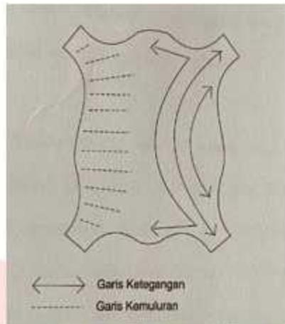
Gambar 14. Arah Ketegangan Dan Kemuluran Kulit
