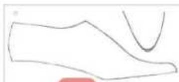
Gambar 9. Acuan Sepatu Pria Dewasa Bentuk Klasik Ujung Runcing
