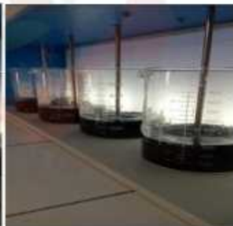
Gambar 7. (b) Jar Tes dengan Koagulan \text{FeCl}_3
