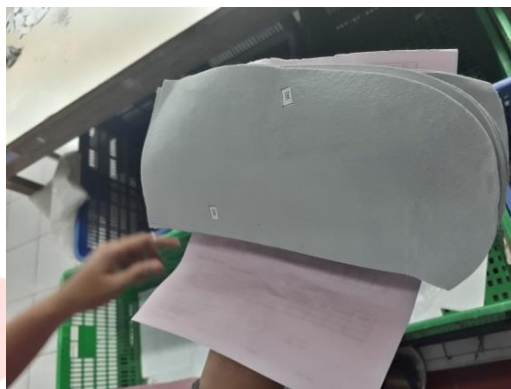
Gambar 12. Pemasangan stiker pada hasil potong proses aradachi.
