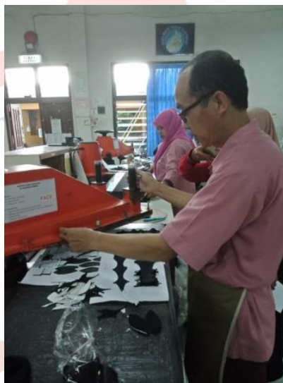
Gambar 13. Pemotongan dengan cutting dies. Sumber: PT. Adi Satria Abadi, 2019
