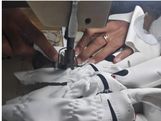
Gambar 16. Pemasangan karet lingkar. Sumber: PT. Adi Satria Abadi, 2019
