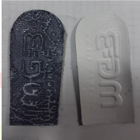
Gambar 24. Ilustrasi proses pengeleman satu sisi.
