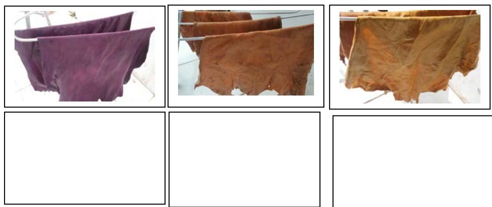
Gambar 4.12 Proses Pengeringan dengan pewarna alami kayu (secang, tingi, tegeran), akar rimpang kumyit , daun indigo
