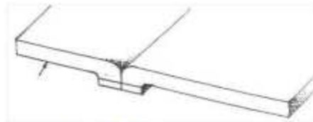
Gambar 15. Open seam (Sumber: Basuki, 2013)
