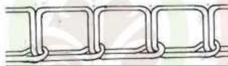
Gambar 7. Konstruksi setik rantai (Sumber: Basuki, 2013)
