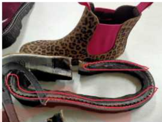
Gambar 17. Hasil tes bonding sepatu Fatbaby material outsole sepatu everlon dengan standar < 5 \text{ kg/cm}^2
