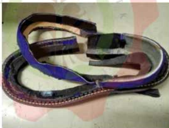
Gambar 18. Hasil tes bonding sepatu fatbaby material outsole sepatu everlon dengan standar \geq 5 \text{ kg/cm}^2
