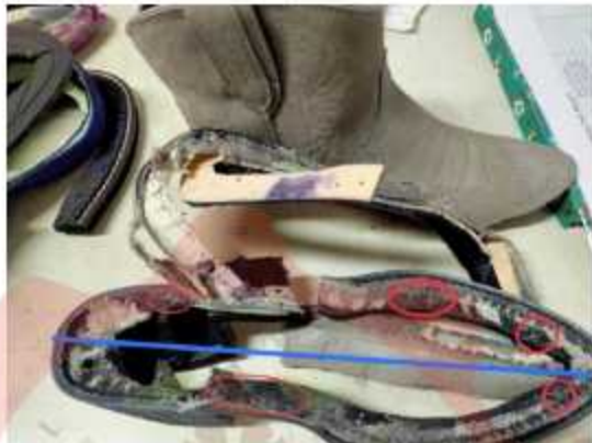
Gambar 11. Penentuan garis khayal pada outsole sepatu Wms Bootie
