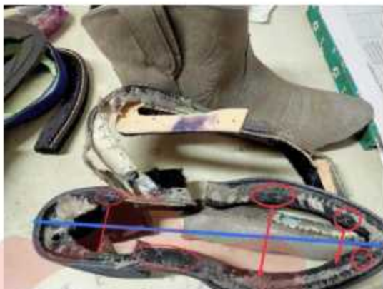
Gambar 12. Penentuan daerah kegagalan tes bonding pada outsole sepatu Wms Bootie
