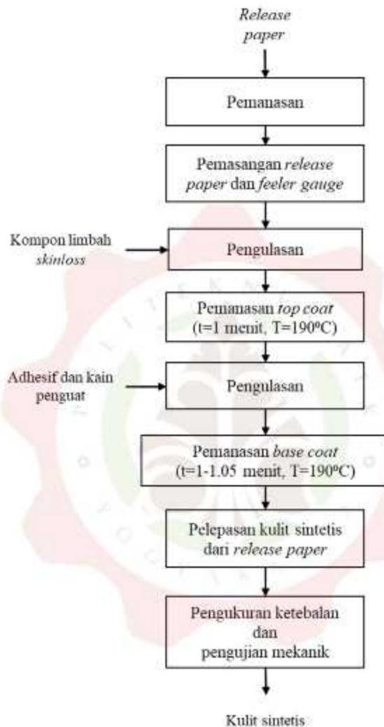
Gambar 3. 2. Skema proses pembuatan dan pengujian kulit sintetis menggunakan skinloss menjadi artikel New Clio
