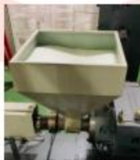
Gambar 3. Hopper Sumber: PT Pangestu Jaya Makmur, 2023
