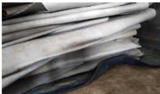
Gambar 7. Bekas lipatan pada kulit wet blue (Sumber PT. Jogja Kurnia Leather)
