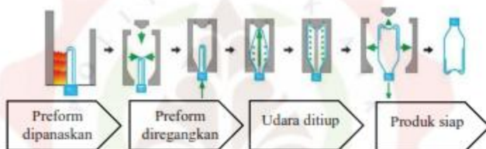
Gambar 2.6 Proses pada Mesin Stretch Blow Sumber: petallmfg.com (2023)
