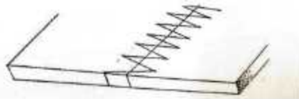
Gambar 7. Zig-Zag Seam (Sumber: Basuki, 2013)
