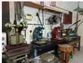
Gambar 1. Mesin Emboss Kulit (Hot Stamping Foil) (Sumber: PT Nandhi Radja Nusantara. 2023)
