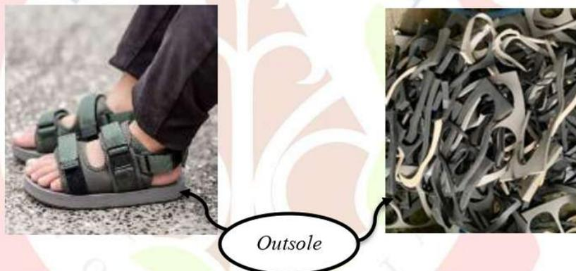
Gambar 2.1 Bagian *Outsole* dan Limbah *Trimming Outsole*
