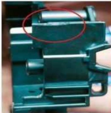
Gambar 7. Cacat Undercut (Sumber : Produk Cacat Undercut PT Patco)
