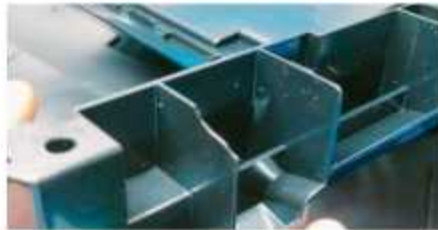
Gambar 5. Cacat Short-Shot (Sumber : Produk Cacat Short-Shot PT Patco)
