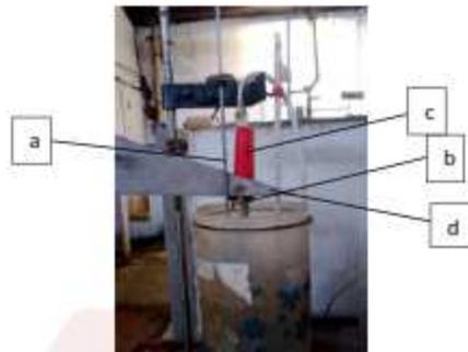
Gambar 19. Alat pengujian suhu kerut
