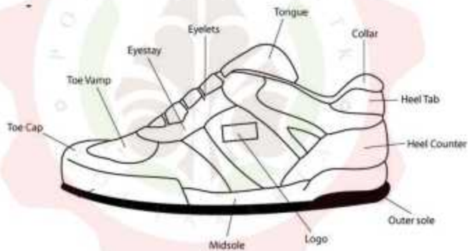
Gambar 6. Bagian-Bagian Sepatu Sneakers (Sumber: Planetsport.asia, 2018)
