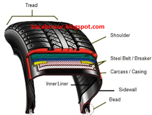
Gambar 2. 2 Komponen Penyusun Ban Radial
