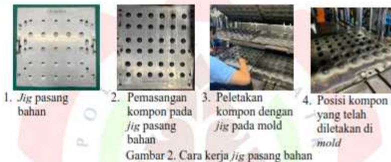
Gambar 2. Cara kerja jig pasang bahan
