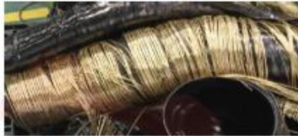
Gambar 2. 4 Kawat baja untuk pembentukan carcass ban radial Sumber: Dokumentasi Perusahaan
