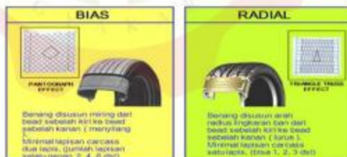
Gambar 2. 7 Perbedaan struktur carcass pada ban bias dan ban radial Sumber: Handoyo (2014)
