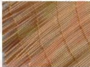
Gambar 2. 3 Nilon untuk pembentukan carcass ban bias Sumber: Group (2025)
