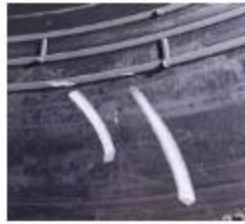
Gambar 2. 10 Cacat retak (cracking) Sumber: Dokumentasi
