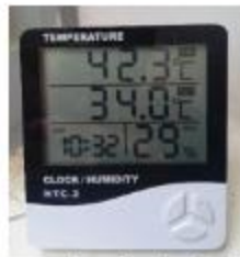
Gambar 3. 3 Alat pengukur suhu dan kelembaban di ruangan vulkanisasi Sumber: Dokumentasi
