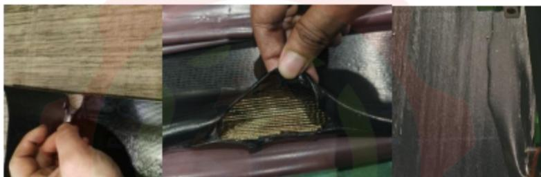
Gambar 2. 7 Cacat delaminasi
