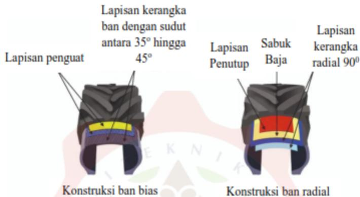
Gambar 2. 1 Perbedaan konstruksi ban bias dan ban radial (Aristyo, 2018)
