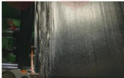
Gambar 2. 9 Cacat potongan tepi *steel cord* buruk
