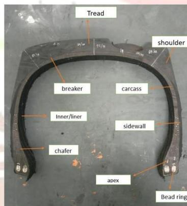
Gambar 2. 2.Struktur *Carcass*
