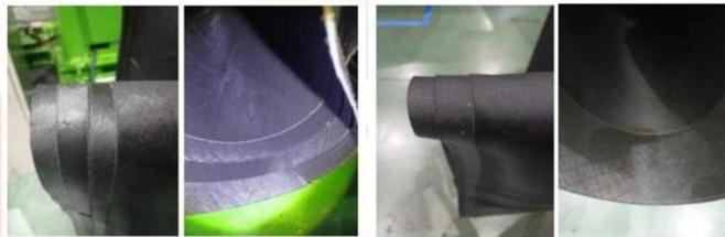
Gambar 2. 6. Susunan *cord carcass*
