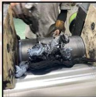
Gambar 13. Proses Pembuatan Kompon FM-EH012
