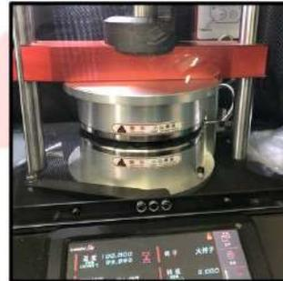
Gambar 15. Proses Pengujian MV (*Mooney Viscosity*)
