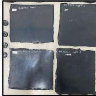
Gambar 14. Sampel Kompon Karet untuk Pengujian Sifat Fisik
