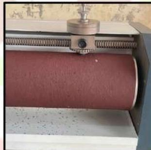
Gambar 20. Proses Pengujian Keausan (*Abrasion Resistance*)
