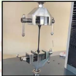
Gambar 23. Proses Pengujian Kuat tarik (*Tensile Strength*)
