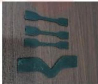
Gambar 3.3 Sampel bentuk dumbbell dan bulan sabit (metode c)
