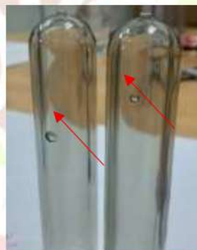
Gambar 9. Cacat Bubbles (Sumber: PT Natamas Plast)
