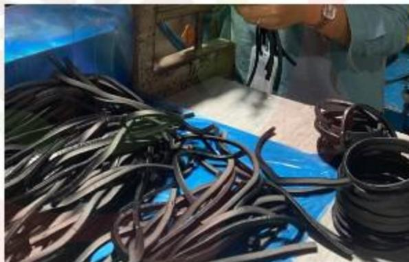
Gambar 3. 11 Potongan Kompon NBR
