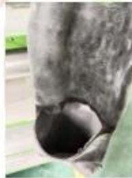
Gambar 6. Sambungan ban dalam yang terbuka atau lemah
