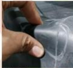
Gambar 8. Contoh cacat gelembung udara dalam produk ban dalam
