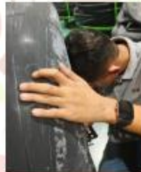
Gambar 5. Proses inspeksi produk jadi ban dalam
