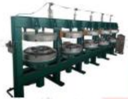
Gambar 4. Mesin vulkanisasi ban dalam.
