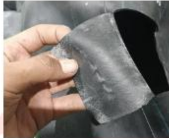
Gambar 9. Cacat produk ketebalan ban dalam tidak rata
