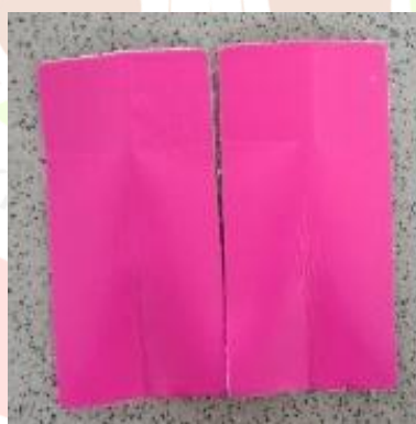
Gambar 24. Hasil Pengujian Flexing Trial 1 100.000 x 2 Sumber: PT X, 2025
