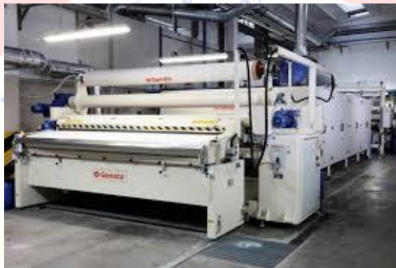
Gambar 1. Mesin Roller Coater Sumber: Gemata, 2025
