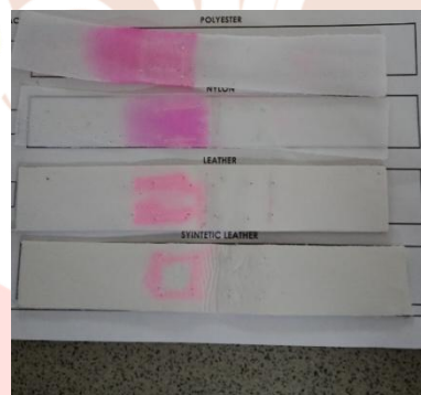
Gambar 14. Hasil Pengujian Wicking Solvent Kulit Kontrol Sumber: PT X, 2025
