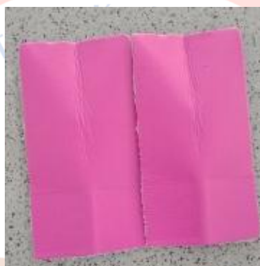
Gambar 23. Hasil Pengujian Flexing Kontrol 100.000 x 2 Sumber: PT X, 2025
