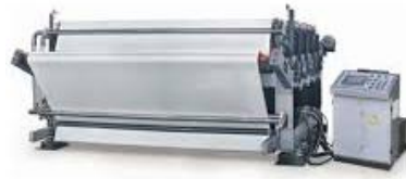
Gambar 12 Mesin Pelemas Kulit Sumber: Shibiao, 2025
