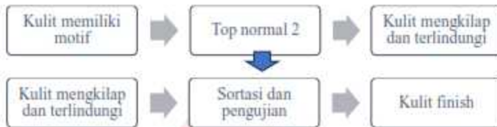
Gambar 12. Skema proses finishing artikel upper shoes
