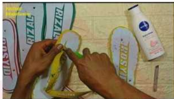
Gambar 2. Pemasangan Upper dengan Metode Sisip Sumber : youtube.com/Belgam_ID
