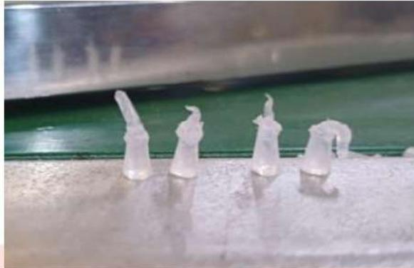
Gambar 7. *inject point* yang sudah dipotong
