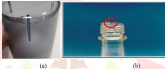
Gambar 2. Cacat Produk *Fliptop* (a) Bintik, (b) Diameter Ulir Cacat
