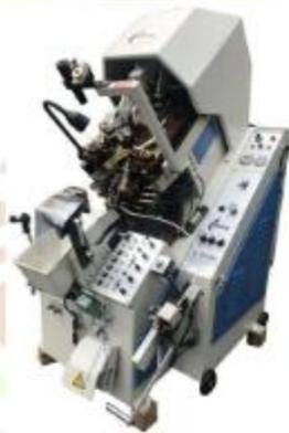
Gambar 13. Mesin *Lasting*
