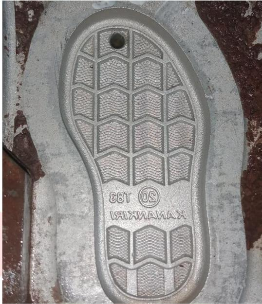
Gambar 12. Cetakan *type kids* percobaan aseton 100%
