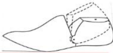
Gambar 21. Conventional Hinged Last (Sumber: Basuki dan Indrati, 1984)
