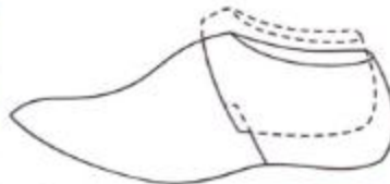
Gambar 22. Telescopic Hinged Last (Sumber: Basuki dan Indrati, 1984)
