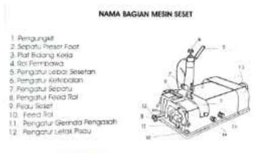
Gambar 10. Mesin Sestet (Sumber : Balai besar kulit karet dan plastik, 2003)
