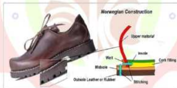
gambar 3 konstruksi norwegian (Sumber: Elzen, 2013)
