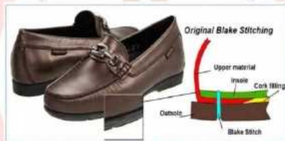
gambar 5 konstruksi blake stitched (Sumber: Elzen, 2013)
