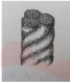
Gambar 20. Konstruksi Continuous Filament (CF) Sumber: Basuki (2013)
