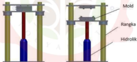
Gambar 2. 5 Skematis dan bagian bagian *clamping unit*
