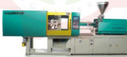
Gambar 3. 2 Mesin Cetak Injeksi Yizumi
