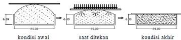
Gambar 6. Prinsip kerja metode konvensional ( Ariyadi, 2019)
