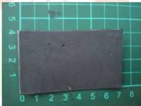
Gambar 14. Tampilan dan Ukuran Spon/eva yang sudah dipotong
