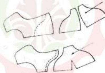
Gambar 7. Komponen foxing/ counter Sumber : (Basuki, 2000)
